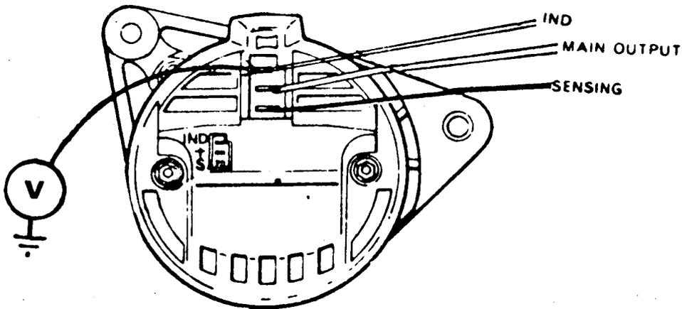
2. Monter ledningsstikket. Forbind voltmeter mellem stel og "ind" terminal - voltmeter aflæsning 1,5 til 3 volt.
