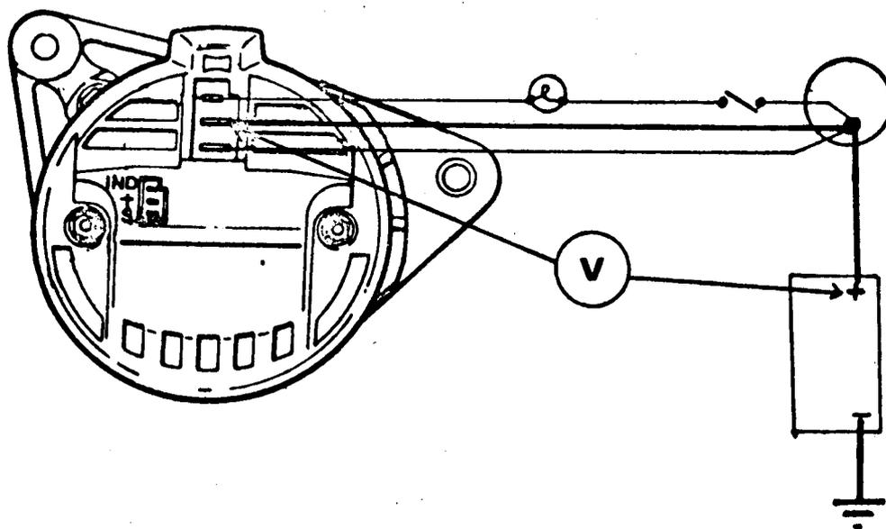
4. Forbind voltmeter mellem batteriets + positive pol og generatorens + terminal. Start motoren og øg hastigheden til ca. 3000 o/m. Voltmeter aflæsning må ikke overstige 0,5 volt.
