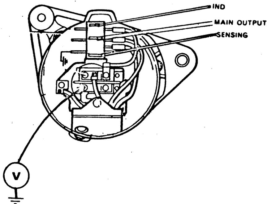
3. Forbind voltmeter mellem stel og "F" grøn ledning på 8 tr relæ (regulatorhus på 14 tr & 11 tr relæ).
