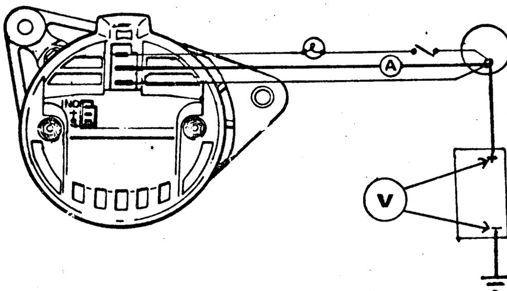
6. Afmonter batteriets stel-kabel, forbind amperemeter mellem start-relæ og generatorens + ledning (brun). Forbind voltmeter over batteriets poler. Monter batteriets stelkabel. Start og øg hastigheden til ca. 3000 o/m indtil amperemeteret viser 10 amp eller mindre. Voltmeter-aflæsning skal være indenfor 13,6 til 14,4 volt.
