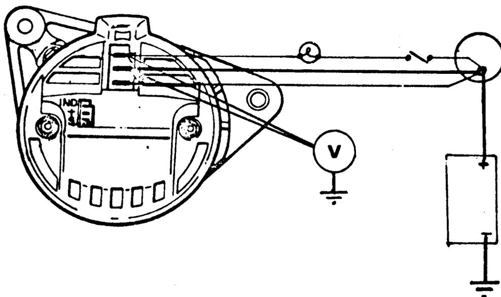
5. Start motoren og øg hastigheden til ca. 3000 o/m. Kontroller spændingen ved hhv. "+" terminalen og "ind" terminalen på generatoren. Voltmeter aflæsning må ikke afvige mere end 0,3 volt.
